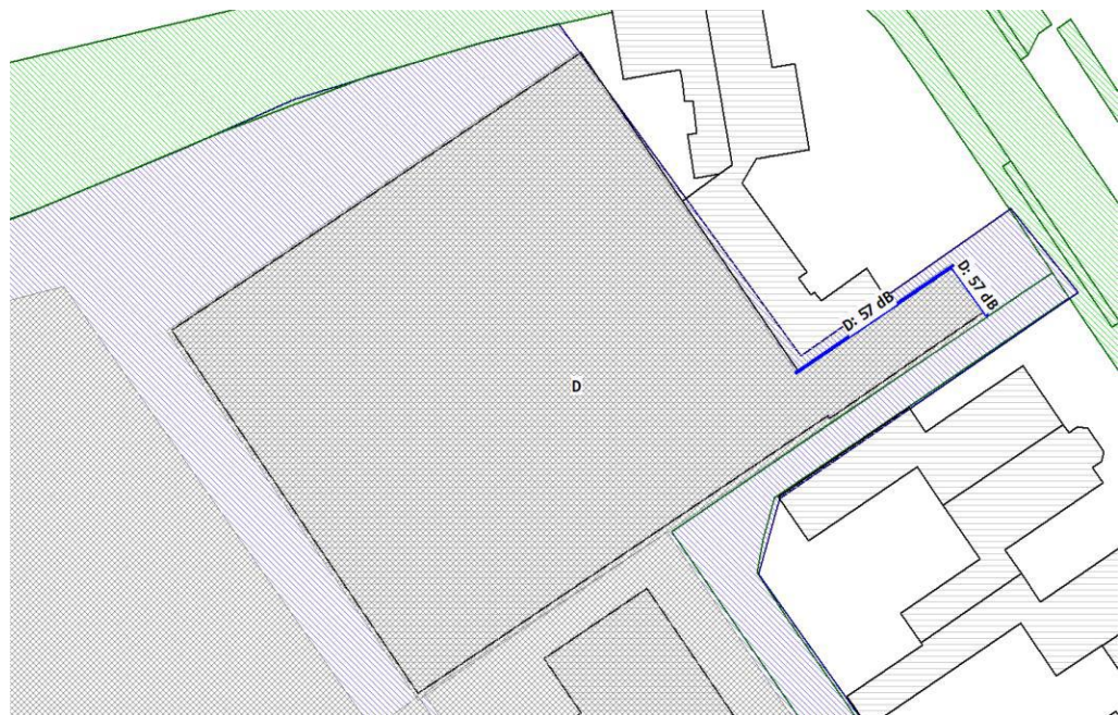
Benodigde hogere waarde voor bouwvlak D ten gevolge van de spoorlijn Bad-Bentheim
