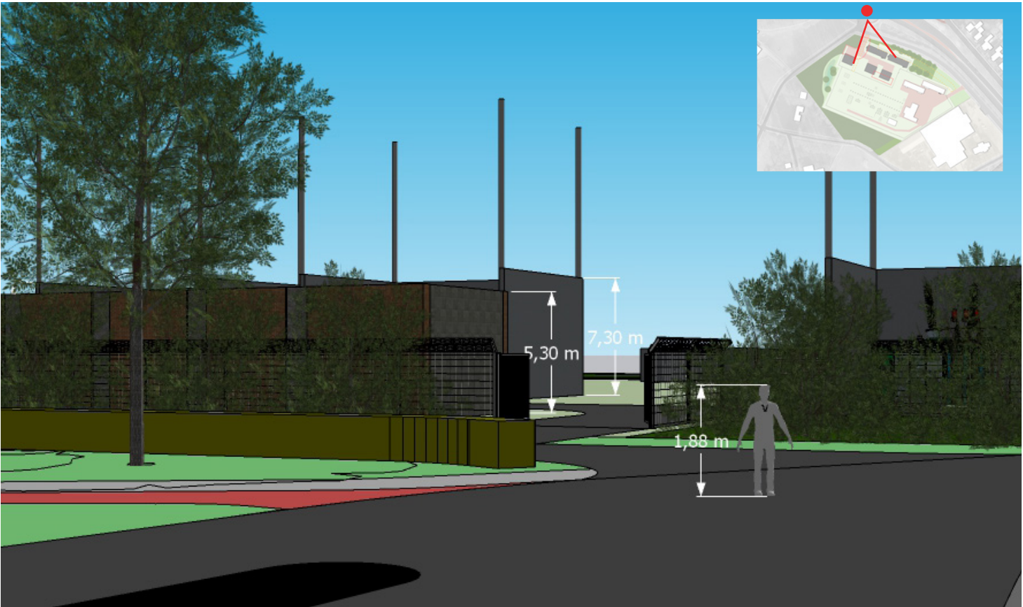
Maatvoering transformator met scherfwanden
