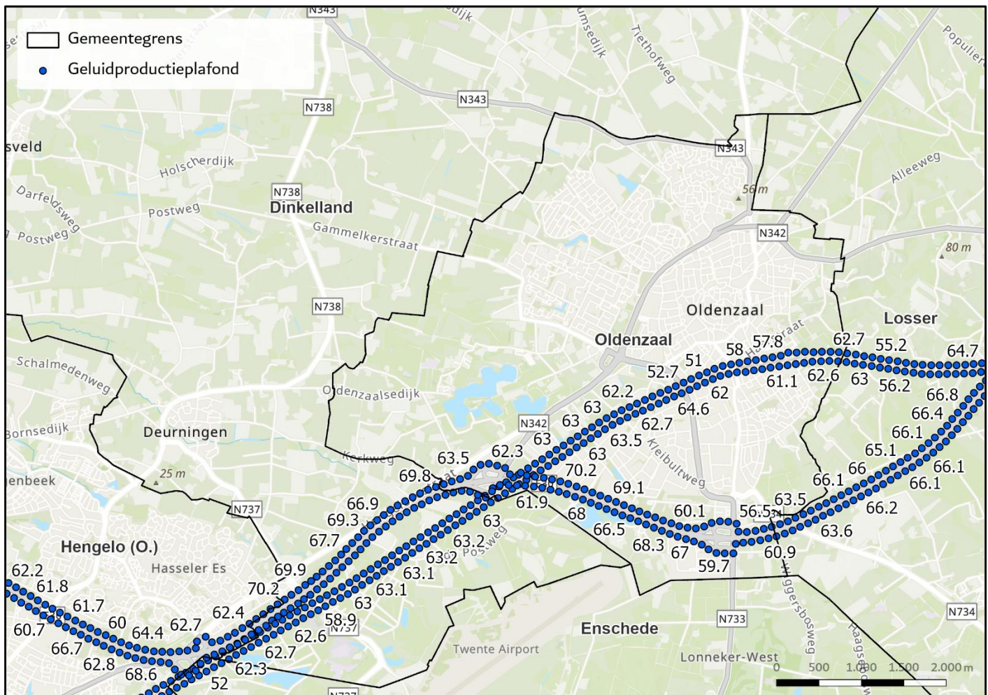
Figuur 5-53 Geluidproductieplafonds (dB) van het spoor en de A1 in Oldenzaal. Bron: Atlas Leefomgeving
