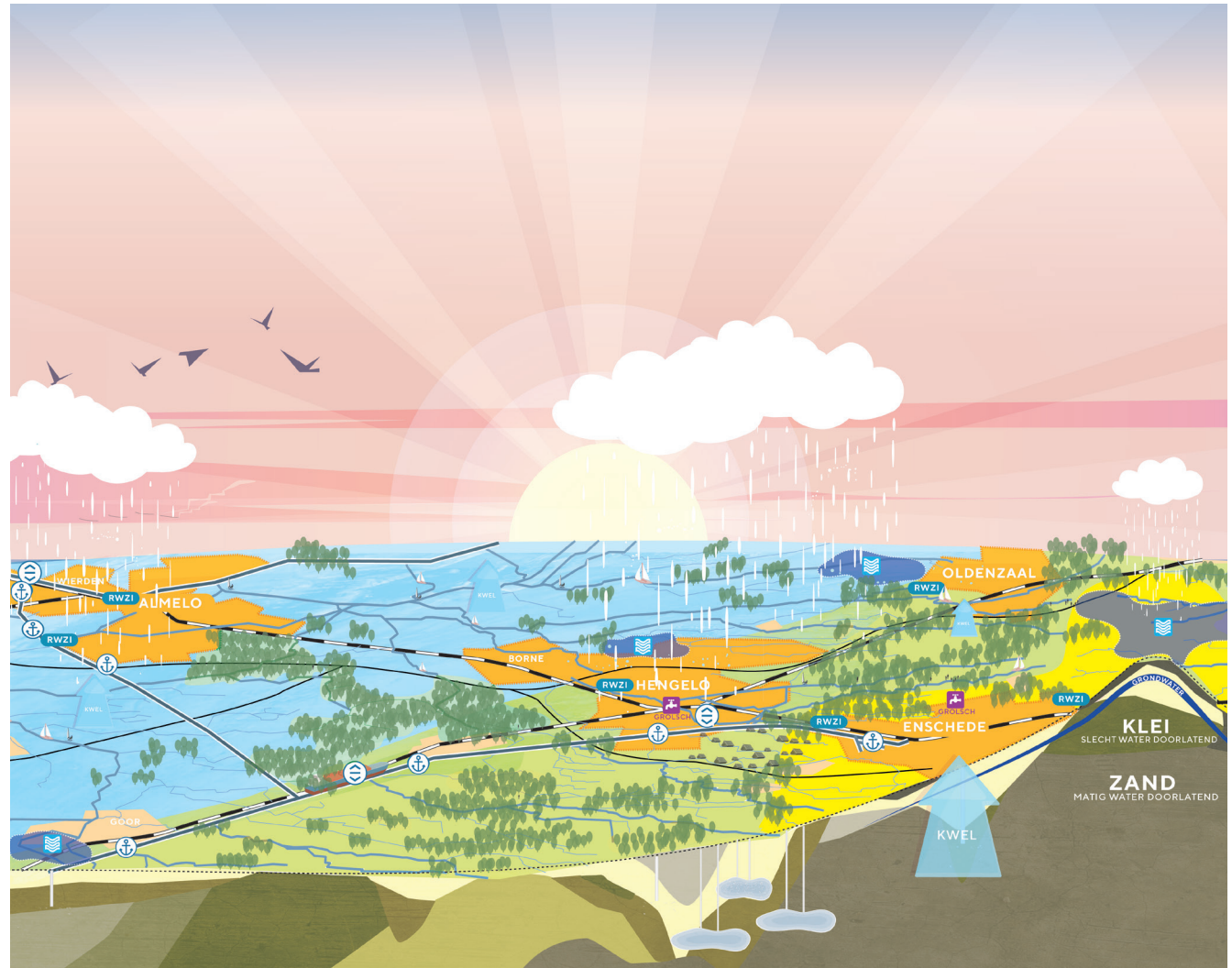
Figuur 1: Opbouw bodem en ondergrond Twente – Waterverkenning Twente 2075
