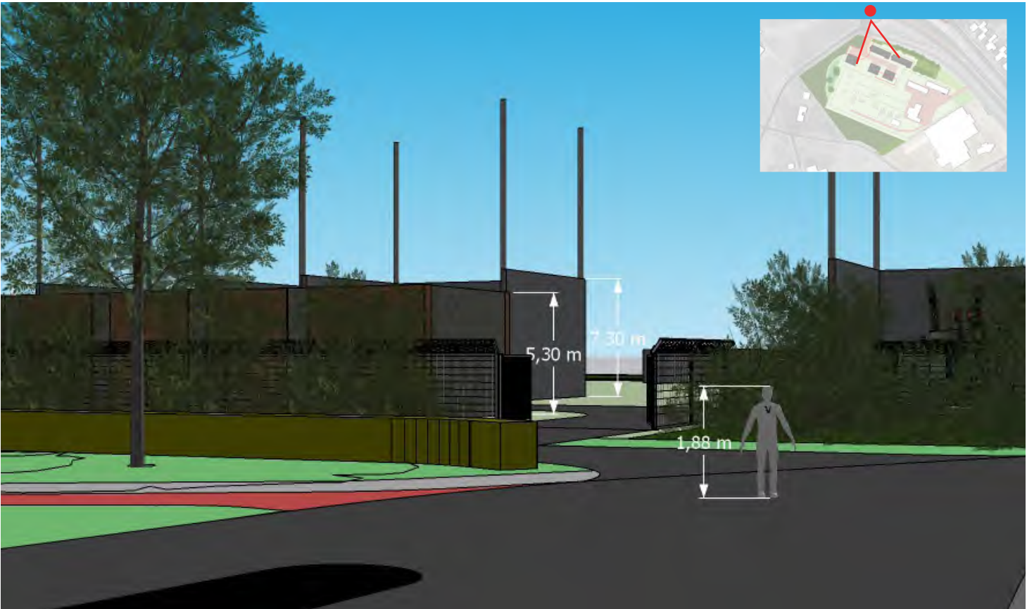
Maatvoering transformator met scherfwanden
